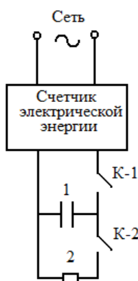
Рис. 2. Принципиальная схема «инвертора реактивной мощности»: 1 – накопитель электрической энергии; 2 – потребитель активной энергии; К-1, 2 – управляемые ключи
