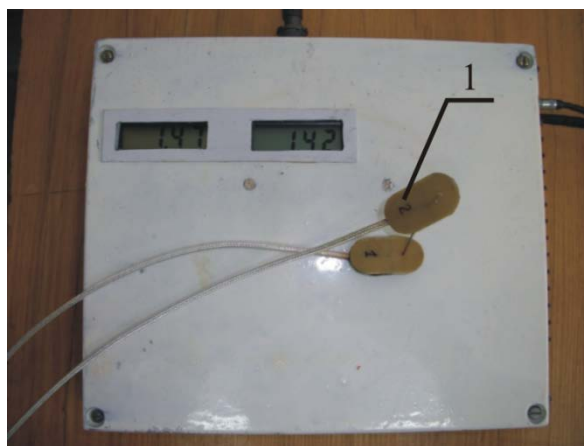
Рис. 2. Общий вид цифрового прибора: 1 – полупроводниковый микротерморезистор типа МТ-54
