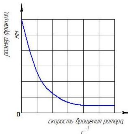
Рис. 6. Зависимость относительного размера фракции от скорости вращения ротора
