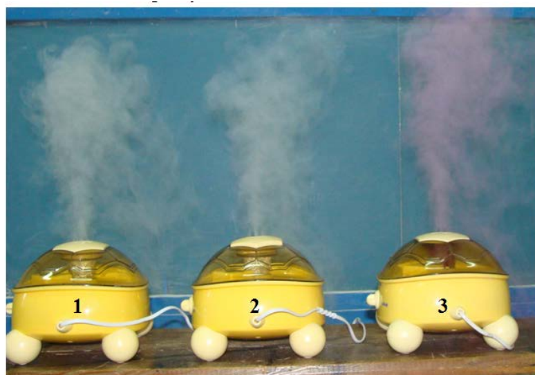
Рис. 2. Ультразвуковая кавитация жидкости: 1 – вода, насыщенная углекислым газом; 2 – водопроводная вода; 3 – раствор удобрений перманганата калия
