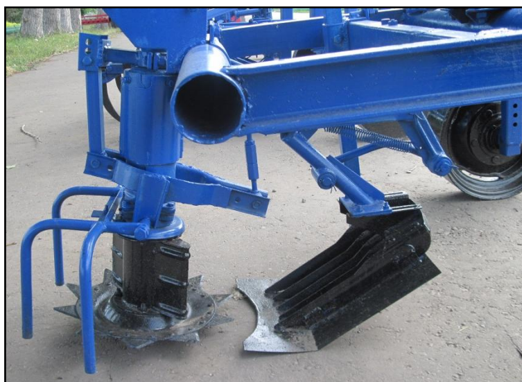
Рис. 3. Рабочие органы машины для отделения отводков
