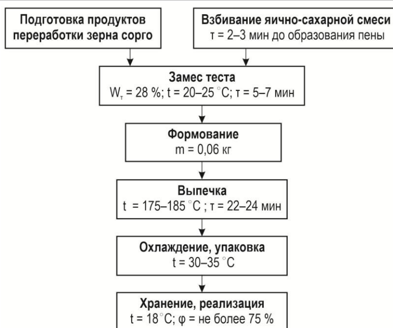
Рис. 2. Схема технологии производства кексов The scheme of cupcake production technology
