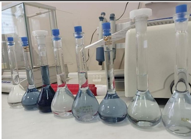
Рис. 1. Появление синей окраски соединений в результате реакции фосфора с фотометрическими реагентами в исследуемых образцах жидкой питательной среды The appearance of a blue color of compounds as a result of the reaction of phosphorus with photometric reagents in the studied samples of liquid nutrient medium
